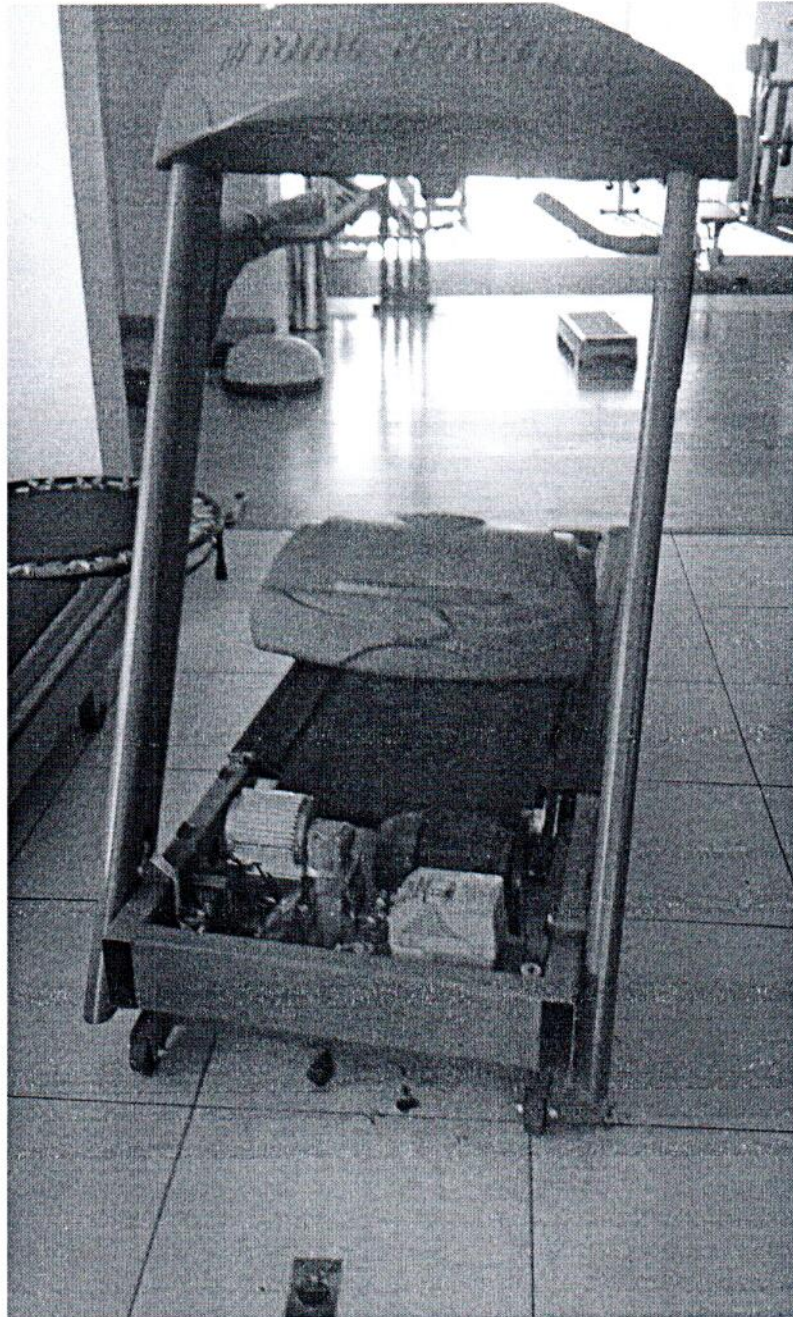
Figura 4 – Esteira com motores elétricos
